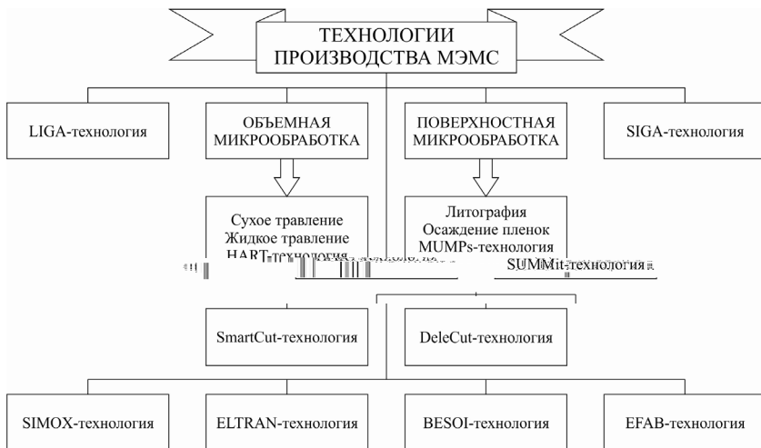
Рис. 2. Основные технологии изготовления МЭМС
