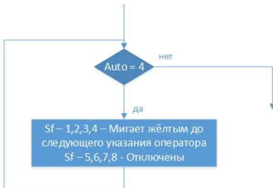
Рис. 3. Блок-схема работы светофора в режиме мигающего желтого
